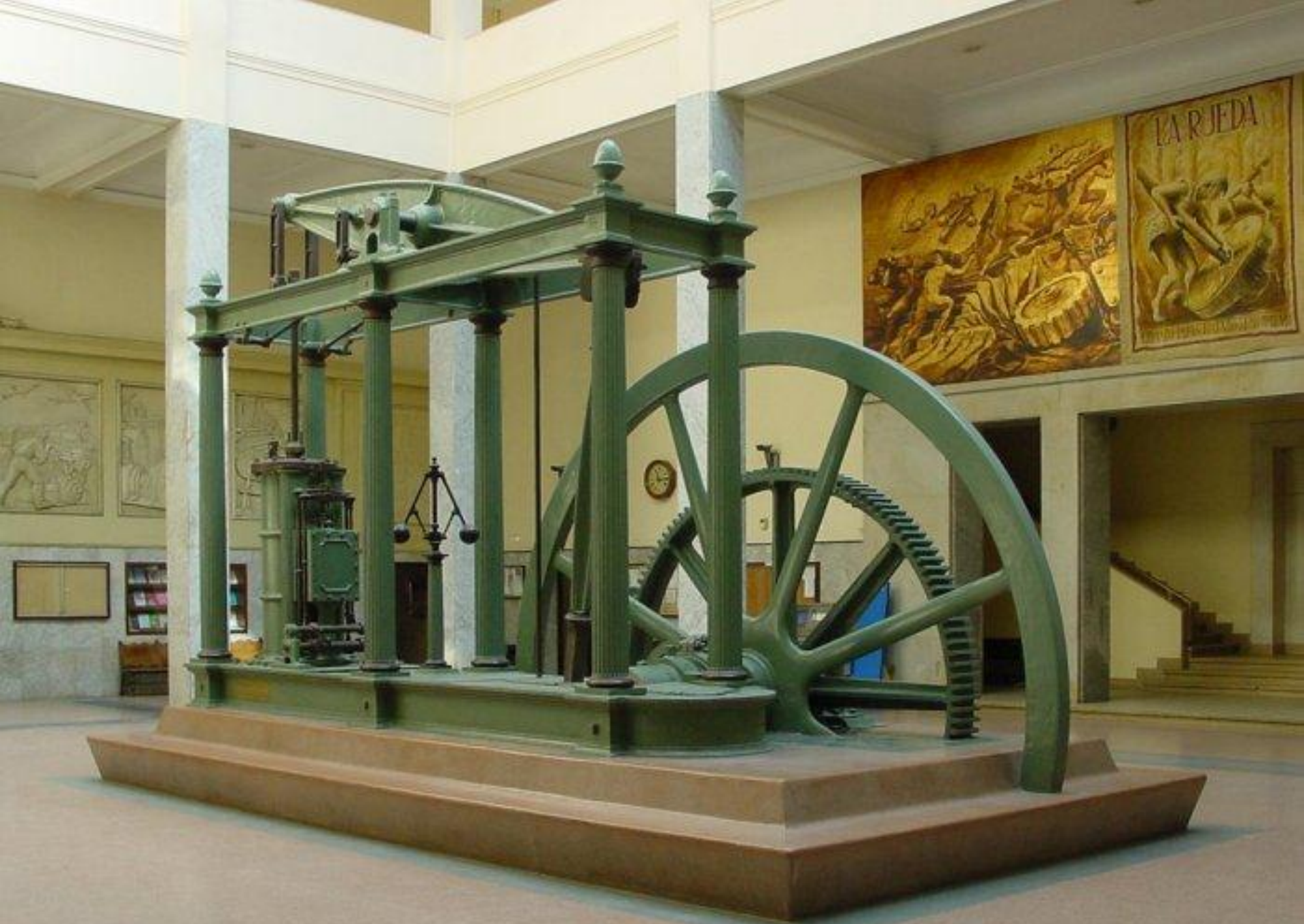
Máquina construida por la compañía David Napier & Son Limited (Londres/1780). Transforma el calor en energía mecánica.
